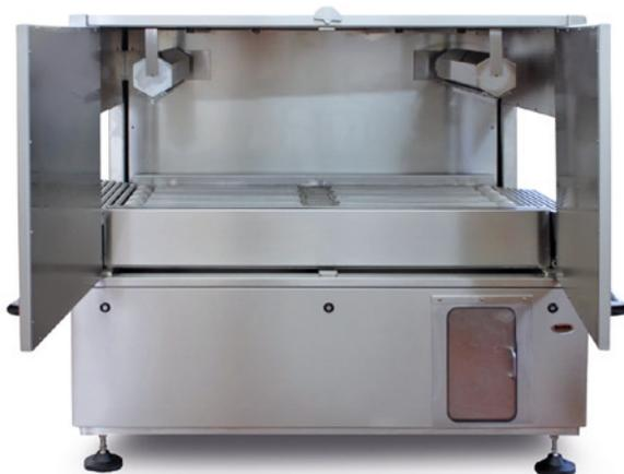
Beim Modell T 1600 A wird durch zwei Hochleistungsgebläse und die flexibel einstellbaren Lüfterdüsen das Trocknungsergebnis bei hohen Kapazitäten verbessert.
