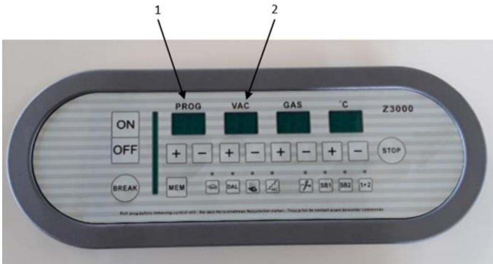
Ahora ajuste el programa 55 en la pantalla "PROG" (véase la ilustración: 1) a través de las teclas +/- y cierre la tapa de la máquina.
