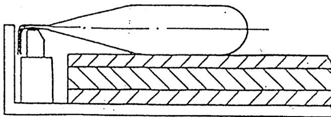
Una vez introducida sobre la barra de soldadura, estire la bolsa para eliminar los pliegues.
