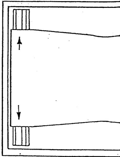
Si la bolsa sobresale más de 8 cm, recomendamos recortar el sobrante. Los sobrantes más cortos de las bolsas pueden introducirse en la ranura entre la barra de soldadura y la pared de la cámara. Sin embargo, asegúrese de que pueda seguir extrayendo correctamente el aire de la bolsa.
