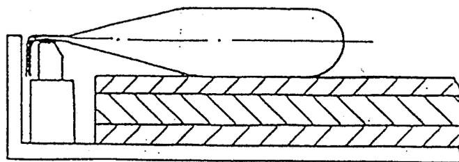
La abertura de la bolsa jamás debe quedar sobre el borde de la cámara, ya que de lo contrario se retraería al cerrar la tapa de la cámara. Como consecuencia puede suceder que no pueda salir el aire durante el proceso de evacuación.
