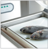
Einlegeplatten zur Volumenreduzierung und Höhenregulierung
